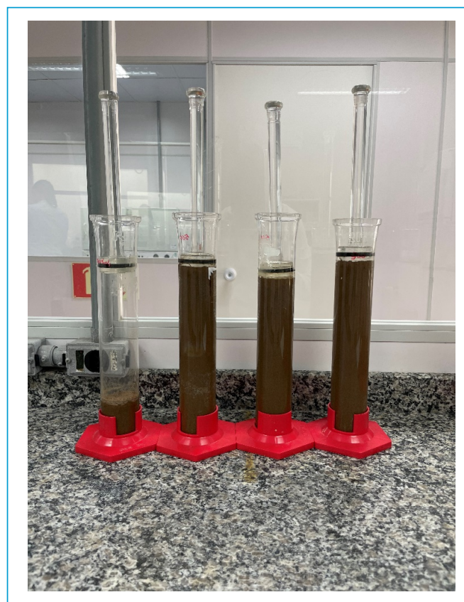
Figura 1 - Sistemas utilizados para contaminação do solo. À esquerda, a coluna controle, seguida das três colunas de contaminação.
