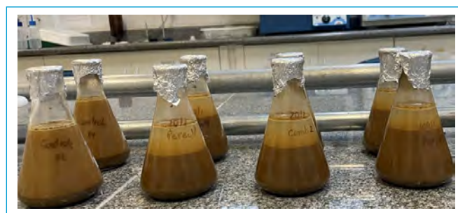
Figura 2 - Sistemas utilizados para remediação do solo em batelada. À esquerda, a coluna controle, seguida das três colunas de contaminação.
